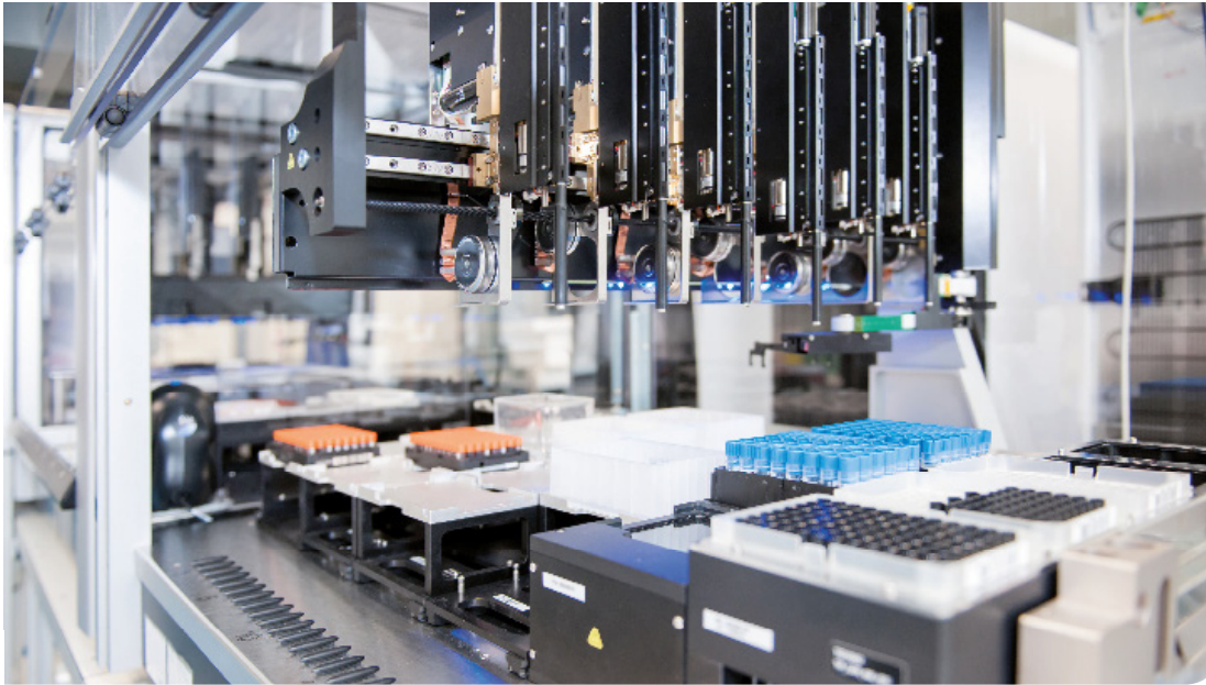
Auf der Suche nach neuen Biomarkern zur Diagnose von Prostatakrebs nutzt das Fraunhofer IZI Pipettierroboter, die RNA aus Gewebeproben isolieren. © Fraunhofer IZI
